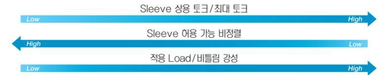
※ Zero 백래시를 위한 끼워 맞춤 설계를 적용한 YL, RD, GR 3종의 슬리브를 각 용도와 상황에 맞게 고려할 수 있습니다. YL < RD < GR 순으로 경도가 점차 높아지며, 이와 관련된 기계적 특성(강성 토크) 등이 증가합니다. 반대로 낮아지는 특성(허용 비정렬)도 선정 시, 참고 바랍니다.
