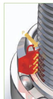
마찰링이 사프트의 나사산에 닿으면 그림과 같이 너트를 조일 때 스프링 효과를 통해 응력(P)이 발생합니다. 반력(P)과 함께 사프트 나사산을 가압하여 자유외전을 방지하는 마찰토크가 발생합니다.
