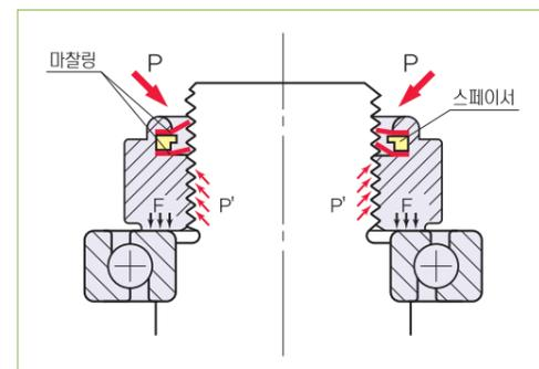
그림(左)과 같이 TWIN FU-NUT에는 두 개의 마찰링과 스페이서가 너트 상단면에 고정되어 있습니다.
